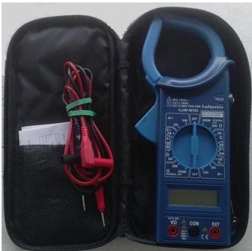
Fig.4: un multimetro digitale portatile
